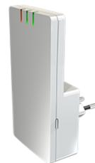
In der Betriebsart „**Satellite Mode**“ (SAT Mode) können die **Speedport** Router der Deutschen Telekom in der DECT-Reichweite verlängert werden. Die DSL-Router müssen hierzu weder angepaßt noch umkonfiguriert werden.
