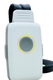
**Anzeige rot** konstant Telefonverbindung bei Hilferuf
