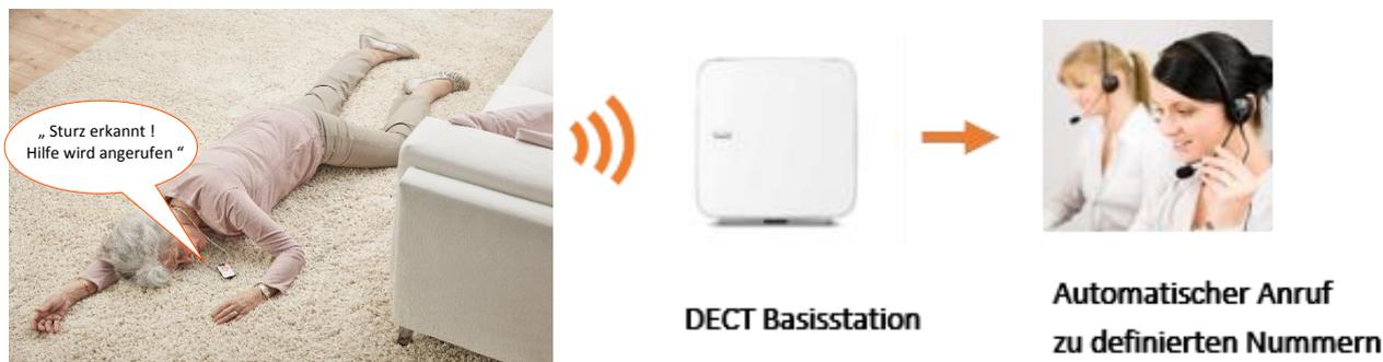
Die Sturzerkennung ist werkseitig voreingestellt und wird automatisch aktiviert, wenn das Gerät von der Ladescheibe genommen wird. Die Sturzerkennung wird unterbrochen, wenn das Gerät mit einem Teilnehmer verbunden ist, also der Nutzer gerade telefoniert.
