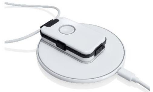
Belassen Sie das Gerät auf der Ladescheibe für mindestens 30 Min. Das Gerät hat im vollgeladenen Zustand eine Standby-Zeit von 3 Tagen. Laden Sie das Gerät regelmäßig, am besten über Nacht. Wenn das Gerät auf der Ladescheibe liegt, wird auch die Rauchalarm-Erkennung aktiviert (siehe Kap 3.8 und Kap 4.2).
