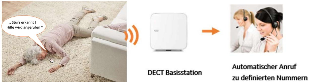
Die Sturzerkennung ist werkseitig voreingestellt und wird automatisch aktiviert, wenn das Gerät von der Ladescheibe genommen wird. Die Sturzerkennung wird unterbrochen, wenn das Gerät mit einem Teilnehmer verbunden ist, also der Nutzer gerade telefoniert.
